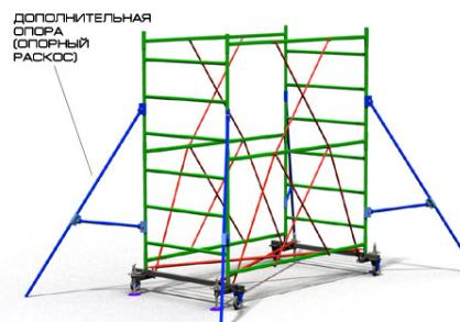
5. В такой последовательности (установка нижних горизонталей, установка боковин, установка верхних горизонталей и затем скрещивающихся стяжек) продолжайте монтаж помоста (туры). Если высота помоста превышает 4м, установите 4 дополнительные опоры.
