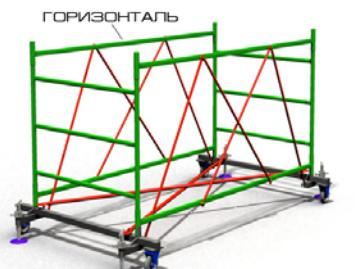
4. Установите в захваты нижних горизонталей скрещивающиеся стяжки и после установки верхних горизонталей вставьте верхние концы всех четырех стяжек с каждой стороны в соответствующие захваты
