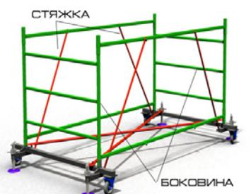
3. Установите боковины в установленные горизонтали и вставьте в боковые захваты рам стяжки, по две с каждой стороны.
