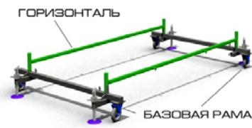
1. Установите параллельно две базовые рамы; вставьте между ними горизонтали
