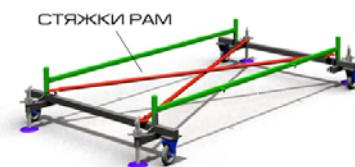
2. Зафиксируйте положения двумя скрещивающимися стяжками, установив их в соответствующие захваты.
