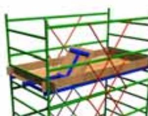
6. Рабочая платформа имеет ограждение, состоящее из двух боковин с расстоянием между перемычками 450 мм и двух поручней, связанных с нижними горизонтальными скрещивающимися стяжками.
