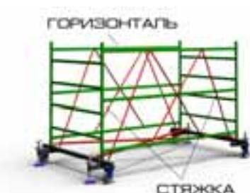
1. Установите параллельно две базовые рамы; вставьте между ними горизонтали
