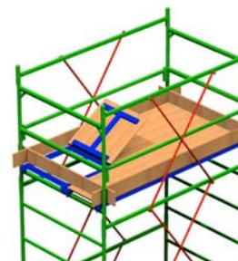
6. Рабочая платформа имеет ограждение, состоящее из двух боковин с расстоянием между перемычками 450 мм и двух поручней, связанных с нижними горизонтальными скрещивающимися стяжками.
