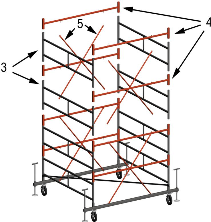
8. Вставить лестницы следующей секции в гантели и, повторяя действия п. 3.4;3.5 и 3.6, собрать вышку на требуемую высоту. Для удобства сборки используйте настилы (6, 6а), переставляя их по мере установки очередной секции. При сборке вышки высотой от 8.7 м. (6 секций) включительно, необходимо установить дополнительную диагональную стяжку (2) на уровне каждой 5-ой секции (6.2 м.) (рис 1.).
